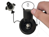
Pomocí nástroje odšroubujte jádro klapky.
