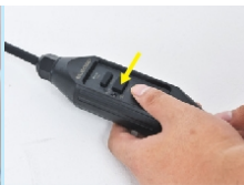
2. Stiskněte tlačítko „RESET“, kontrolka se rozsvítí červeně.
