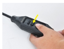
4. Stiskněte znovu tlačítko „RESET“; kontrolka kontrolka se rozsvítí. Diferenciální ochrana funguje správně.
