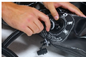
8) Nafouknutí je dokončeno, odstraňte nafukovací hadici.
